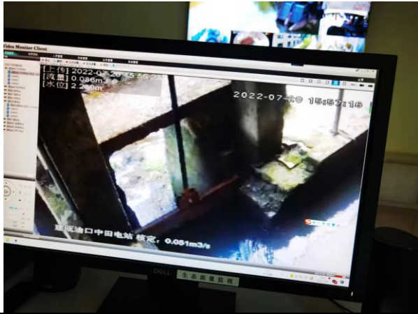
集控中心（下泄流量监控）
